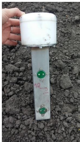
1. ábra: A kísérletben használt, fejlesztés alatt álló szonda (Fotó: Dobó Zs)
