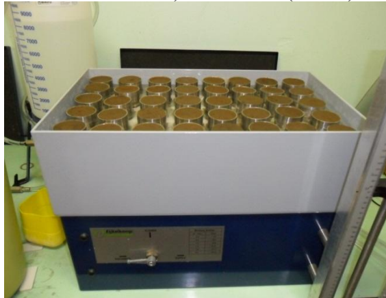
2. ábra. A pF-értékek meghatározására szolgáló homokágy-készülék
