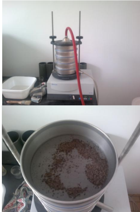
5. és 6. ábra. Retsch AS200 szitázó gép nedves szitálásra alkalmas feltétellel.
